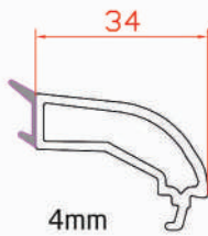
Single Glazing Bead Profile Unique Parclose بروفيل نافذة أحادية الزجاج
