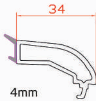
Single Glazing Bead Profile Unique Parclose بروفيل نافذة أحادية الزجاج
